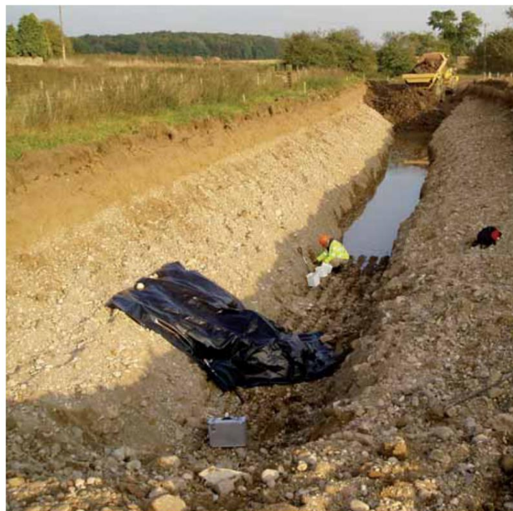
图12：河流沉积物采样现场 在 Yorkshire Ripon 附近采样河流砾石：使用黑色塑料防水布排除光线，样品收集在厚黑色塑料袋中（摄影：G.A.T. Duller）。
